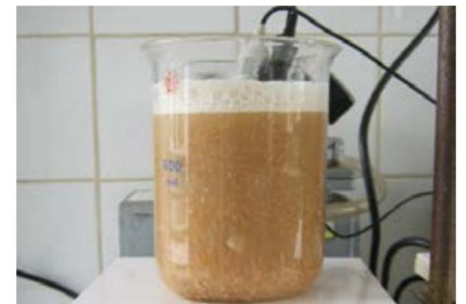
Hydrolyse enzymatique de carapaces de crabes à température et à pH contrôlés
