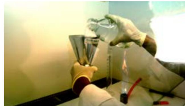
Filtration des échantillons sous hotte à flux laminaire verticale
