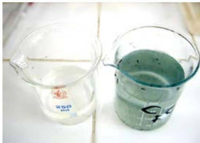
Figure 3 : Eau d'imprimerie traitée / Eau d'imprimerie brute / Fixation de colorants par le chitosan
